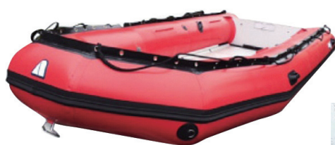
トリマラン構造 (3本のエアキールにより、抵抗を軽減する構造)
