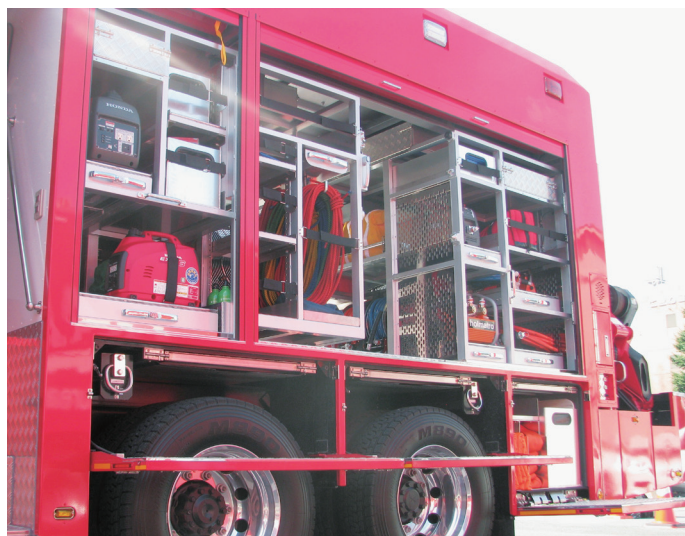
積載庫中央の大型キャビネットは車両の進行方向に対し、縦軸方向に可動します。
