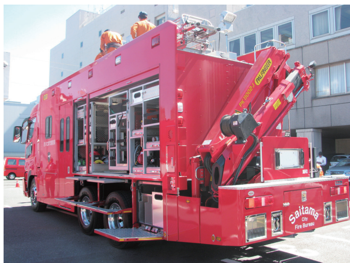
積載庫中央の大型キャビネットは車両の進行方向に対し、縦軸方向に可動します。
