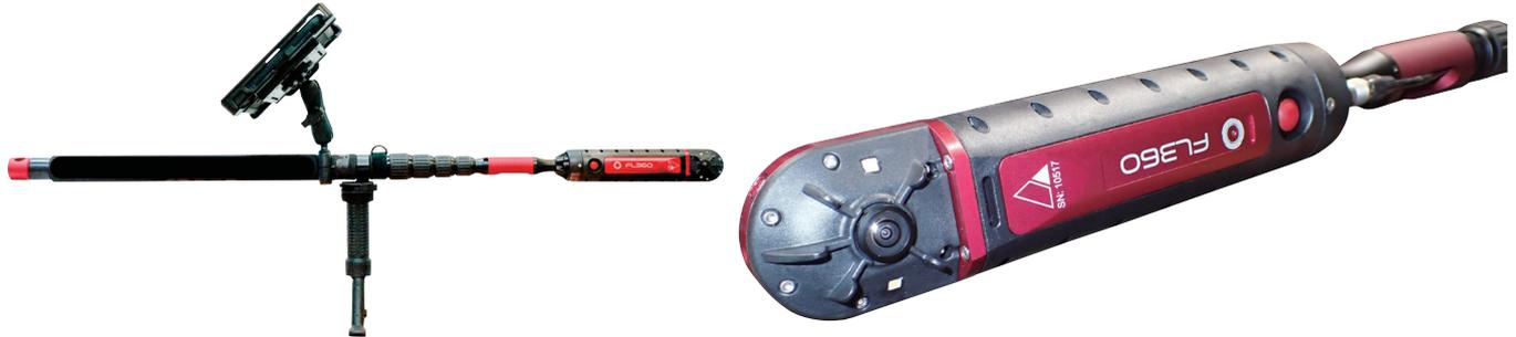
ファーストルック 360 は、専用設計されたソフトウェアを搭載した視野角 360 度の救助用画像探索装置です。左右に各 1 枚、計 2 枚のレンズを備えています。それぞれのレンズが片面をカバーし、2 枚のレンズの捕らえた画像を専用アプリで合成することで全周の視野を捉えます。360 度簡単操作、高い信頼性、頑強、機械的可動無し、直感的インターフェース機器です。先端カメラ部には、LED 照明装備。またマイク、スピーカー付きなので双方向音声コミュニケーションが行えます。検索画像は日時、GPS 位置情報とともに記録できます。通常使用で作動時間は約 5 時間です。
